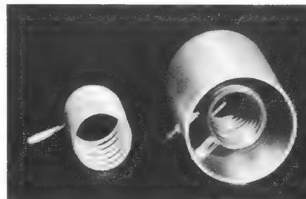
Bild 6. Wendel-Topfkreis für f = 110 MHz, Q = 1200 , b = 3,5 mm (berechnete Werte Q = 1500 und b = 5 mm). Links der Innenleiter, rechts der vollständige Kreis mit angezapftem Innenleiter und Trolitstütze
