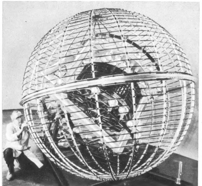
Erdsatellit Tiros II für die Großraum-Wetterbeobachtung mit zwei Kameras und Bildentwicklungs- und -sendeanlage wird hier vor seinem Start in einem Käfig geprüft, der das Magnetfeld der Erde im Weltraum nachbildet. Starke Lampen dienen der Funktionsprüfung der 9260 Siliziumzellen („Sonnenbatterien“)
